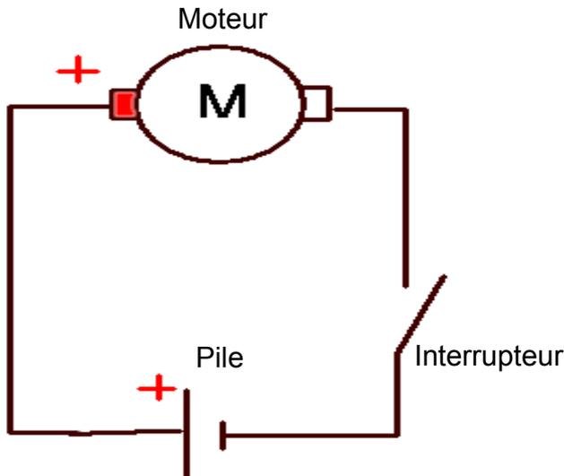
Le moteur ne tourne pas car le circuit est ouvert (Interrupteur non actionné)
