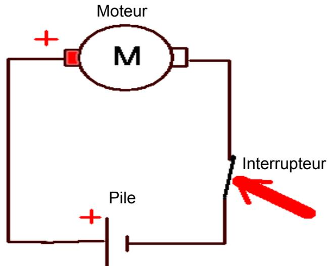
Le moteur tourne car le circuit est fermé (Interrupteur actionné)
