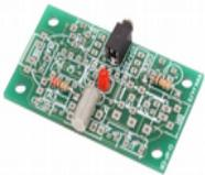
Établir un contact électrique grâce au déplacement d'une bille contenue dans le tube métallique.
