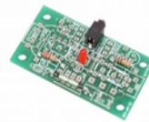
Établir ou couper une connexion en fonction d'un champ magnétique (aimant)
